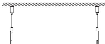
Pour ajuster la hauteur de suspension appuyer sur le petit cylindre situé à la base du cylindre principal puis tirer ou pousser simultanément sur le câble de suspension. Une pression sur le cylindre permet de déverrouiller le câble de suspension.
